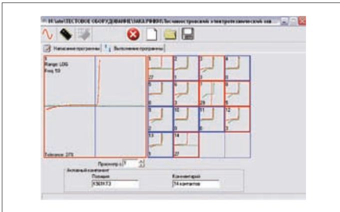
Рис.2. Отображение аналоговых сигнатур с указанием дефектного вывода ИМС
