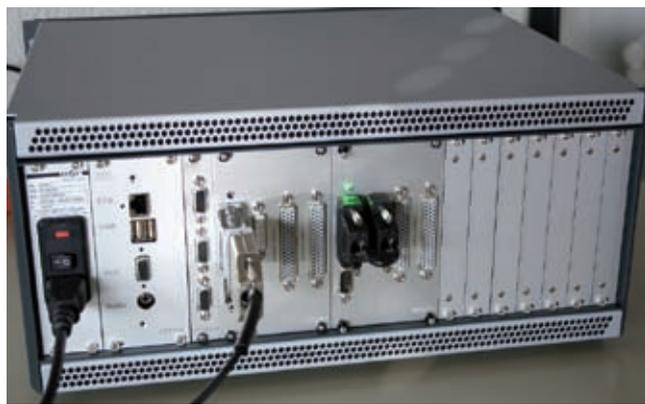
**Рис.2. Вставные модули со своими передними панелями, монтируемые на задней панели корпуса. Сверху и снизу – пространство для подачи холодного воздуха и отвода тепла**
