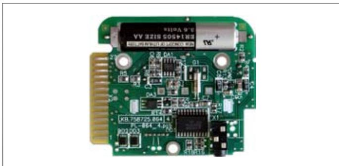
Рис.5. Электронный блок для счетчика газа
