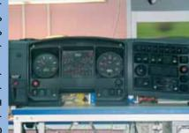
составе современные инструменты фирм Teradyne, Geotest, NI и COBTECT ATE. Система машинного зрения выполнена на базе видеокамеры JAI, интерфейса GigE и программного обеспечения NI. Быстрая и надежная коммутация разъемов жгута проводов приборной панели обеспечивают адаптеры разработки COBTECT ATE.
