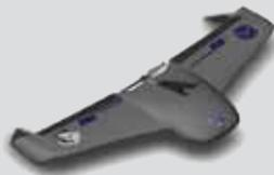
лететь вблизи нее). Чтобы БЛА точно "приземлился" и подлетая к линии электропередачи не налетел на нее, концы его крыльев закручены вниз. При снижении скорости полета аппарата вихревой поток у концов крыльев возрастает, что приводит к стабилизации его положения, т.е. концы крыльев служат "якорем" аппарата и тем самым позволяют точно "приземлиться" на проводе.
