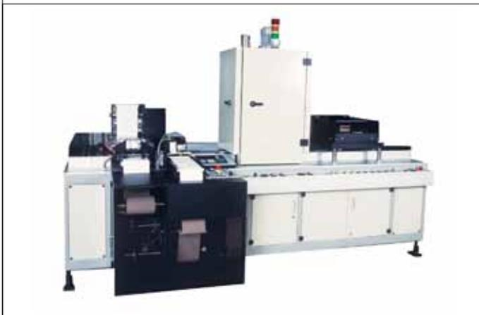
Рис.1. Принтер-стежер PAL-9Y
