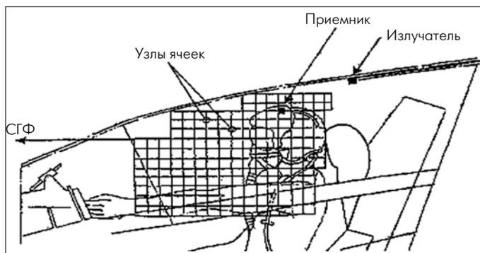
**Рис. 1. Разделение рабочей зоны на дискретные ячейки. СГФ – строительная горизонталь фюзеляжа**
