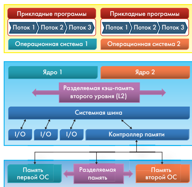
Рис.2. Принцип реализации асимметричного мультипроцессинга (ASMP)
