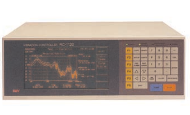
Рис.8. Система управления одноосной вибрацией RC-1120
