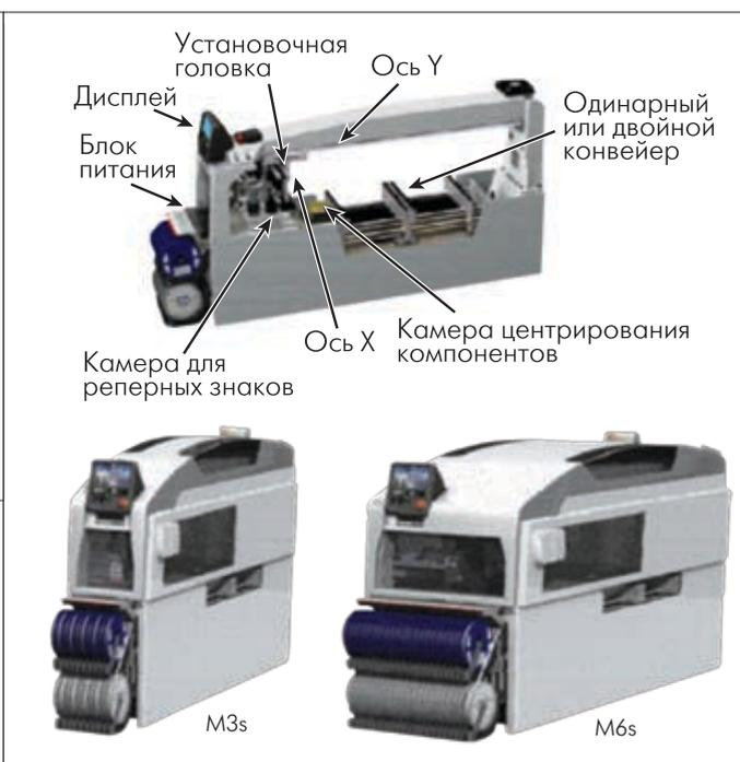
**Рис.3. Установочные модули**
