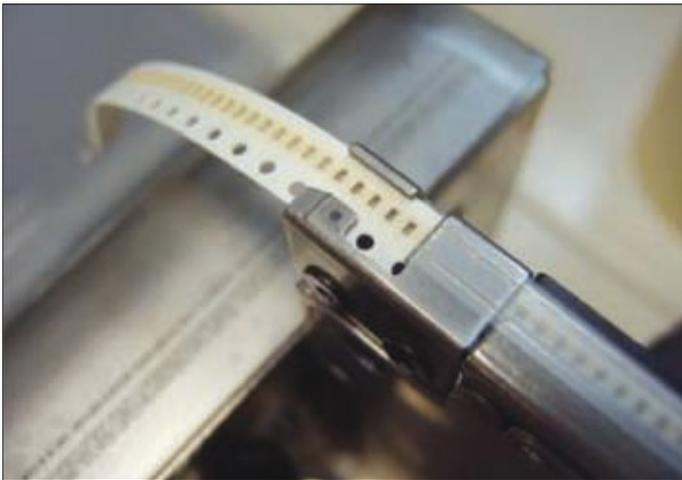
**Рис.7. Реперный знак на питателе и перфорация ленты для корректировки места забора компонента**
