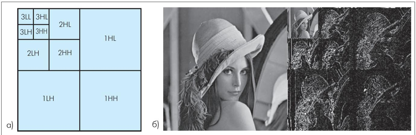
**Рис.4. 2-D вейвлет-разложение: а – подполосы вейвлет-образа сигнала (цифра – номер уровня разложения); б – пример двухуровневой разделимой вейвлет-декомпозиции (Lena.bmp, фильтр - 2bior2.2)**
