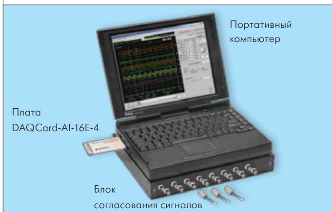
Рис.1. Исполнение регистратора на базе DAQCard-AI-16E-4
