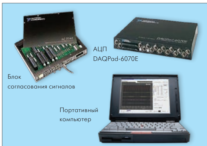
Рис.2. Исполнение регистратора с внешним АЦП DAQPad-6070E
