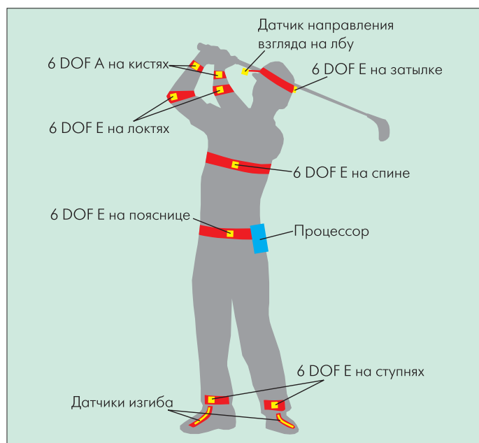
Рис.6. Некоторые датчики на теле оператора при электромагнитном позиционировании спортивных движений. 6DOF E – электромагнитный датчик, обеспечивающий позиционирование по шести степеням свободы (DOF – degree of freedom); 6DOF A – датчик на акселерометрах, обеспечивающий позиционирование по шести степеням свободы
