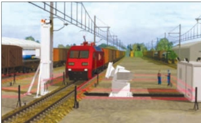
**Рис.3. Инспекционно-досмотровый комплекс для проверки железнодорожных вагонов**
