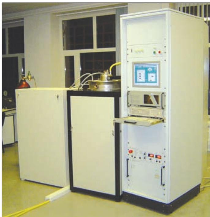
**Рис.4. Установка синтеза алмазных пленок в СВЧ-плазме УПСА-100**
