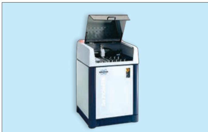
**Рис. 7. Рентгенофлуоресцентный спектрометр S4 PIONEER**
