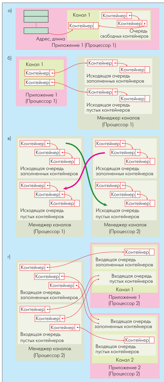
Рис.2. Обмен контейнерами: а – заполнение контейнера, б – помещение контейнеров в очереди, в – обмен данными, г – помещение обработанных контейнеров в очереди каналов
