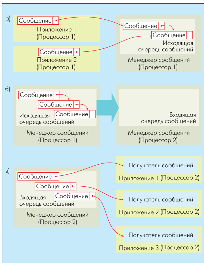
Рис. 1. Передача сообщений: а – помещение сообщения в очередь, б – передача очереди сообщений менеджеру сообщений на другом процессоре, в – выдача сообщений получателям
