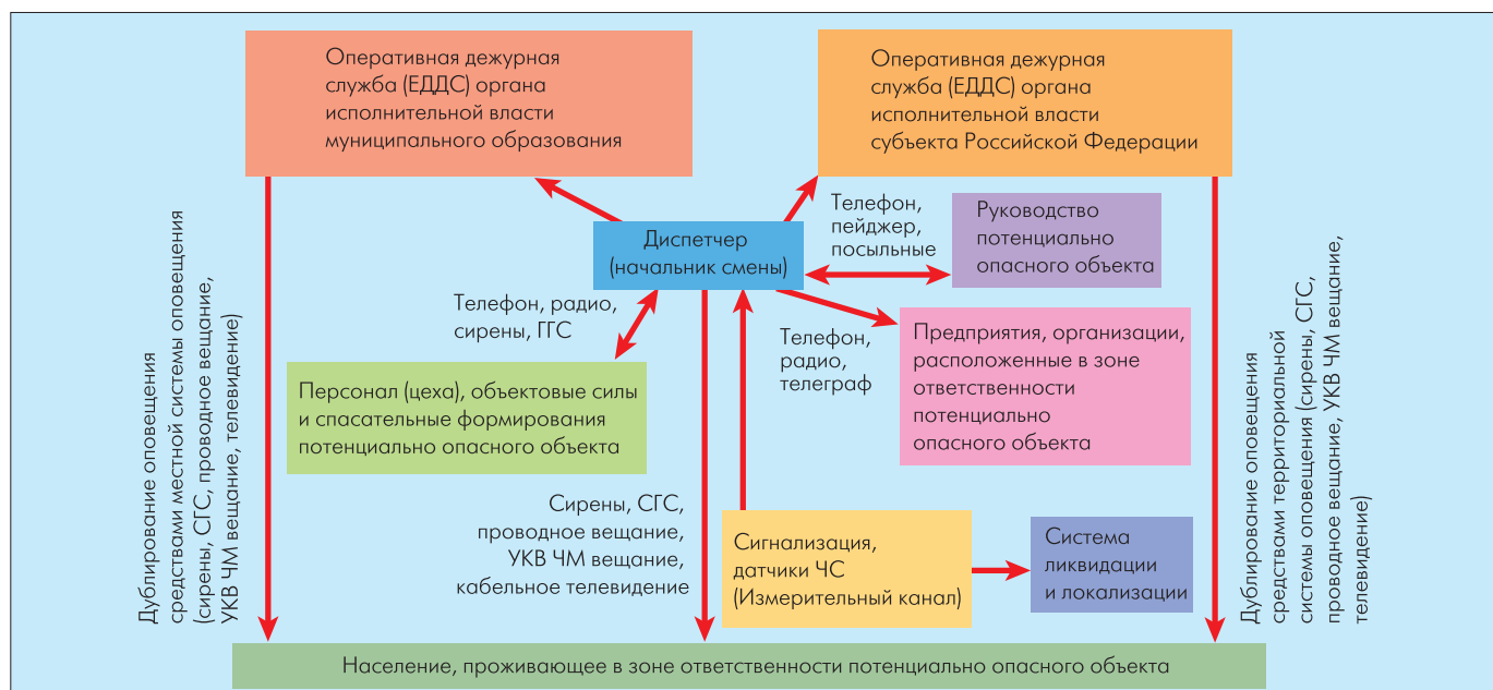
Рис. 1. Типовая схема организации локальной системы оповещения в районе размещения потенциально опасного объекта
