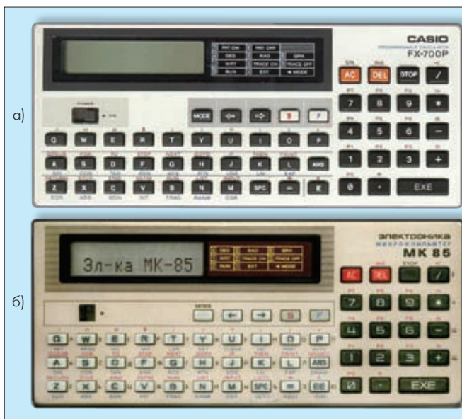
Рис.1. КПК моделей Casio FX700P (а) и “Электроника МК-85” (б)
