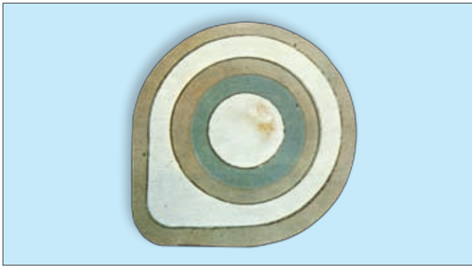
Рис.7. Первый планарный транзистор типа “бычий глаз”, положивший начало второй транзисторной революции
