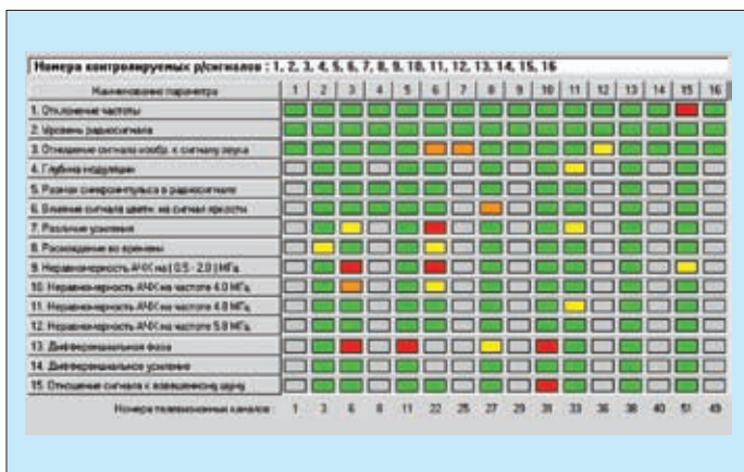
Рис.3. Суммарная статистика состояния контролируемых параметров ТВ-радиопередатчика по входу и по выходу за заданный период времени
