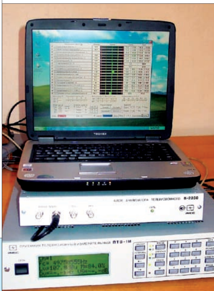
Рис.5. Многоканальная станция автоматизированного дистанционного мониторинга по эфиру С-900
