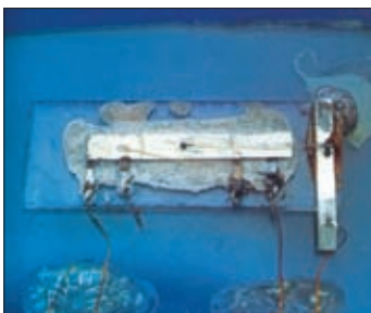
Рис.3. Первая интегральная схема компании Texas Instruments (1959 год, один транзистор и четыре дополнительных элемента на одном кристалле)
