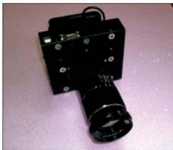
Рис. 3. Вид камеры с охлаждением
