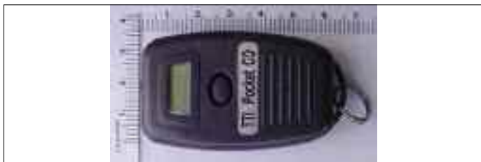
Рис. 1. Карманный детектор CO модели Pocket CO
