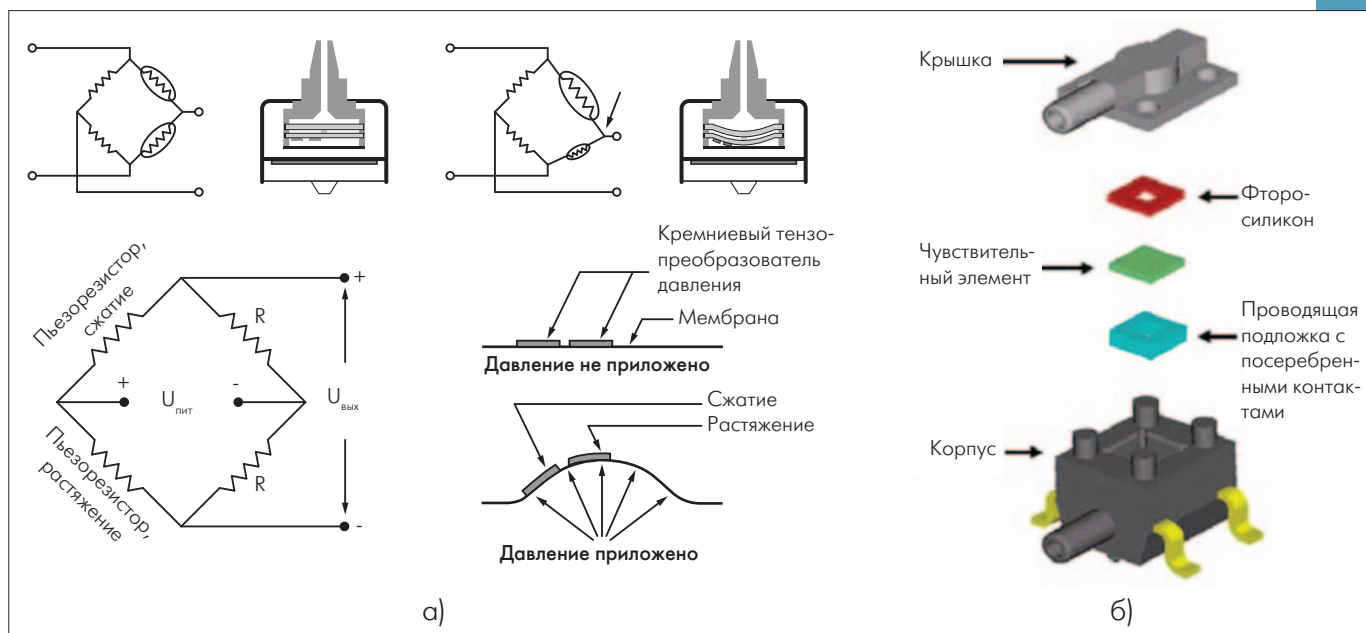
Рис. 1. Принцип действия (а) и конструкция (б) датчиков давления Honeywell
