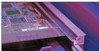
**Рис.6. Система транспортировки печатной платы**
