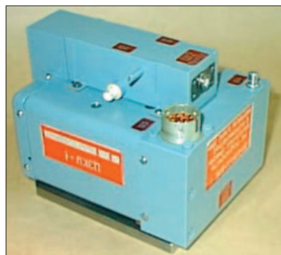
Рис.3. Циклотронное защитное устройство 3-см диапазона. В верхней части – транзисторный усилитель (разработчик – НПП "Исток")
