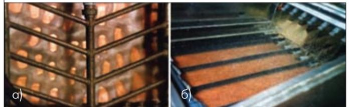
**Рис.5. Системы полива: а) обычная: турбулентные явления и проблемы слива; б) система TFS с боковыми соплами: полное отсутствие турбулентности**
