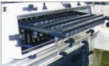
**Рис.7. Система полива S с легкодоступной рамой с форсунками**
