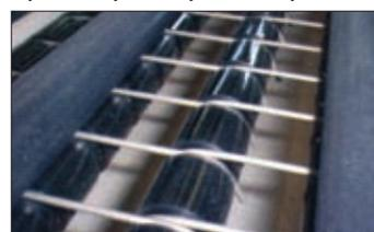
**Рис. 1. Титановые мостики между роликками в установке серии FLEX для обработки тонких и гибких печатных плат**
