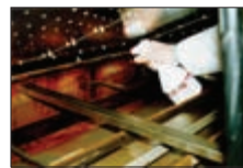
Рис.9. Очистка печей оплавления с использованием VIGON® RC 101
