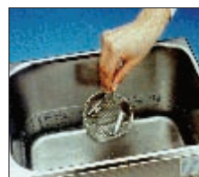
Рис.10. Очистка игл дозаторов с помощью ZESTRON® ES 200
