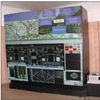
**Рис. 11. Составной экран в конфигурации 2x3 модуля в сейсмоустойчивом исполнении**
