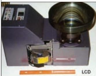
**Рис.6. Электронно-оптический модуль на основе АМ ЖК-модулятора с диагональю 6,4"**
