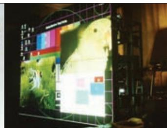
**Рис.7. Составной экран с использованием АМ ЖК-электронно-оптического блока с диагональю 6,4"**
