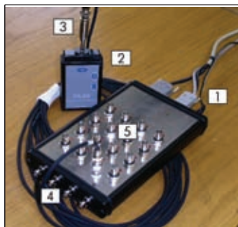
Рис.3. Коммутационная коробка BK-161CP: 1 – кабели подключения к ПК; 2 – пистонфон; 3 – измерительный микрофон с ИСР-питанием; 4 – выходы генератора-формирователя сигналов; 5 – ВНС-разъемы для подключения измерительных микрофонов с ИСР-питанием
