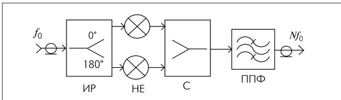
Рис.12. Умножитель/делитель частоты с компенсацией гармоник
