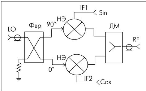
**Рис.10. Квадратурный модулятор/демодулятор**
