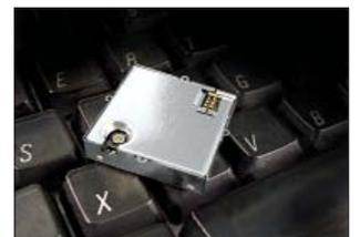
**Рис.3. Модуль Lassen SQ**
