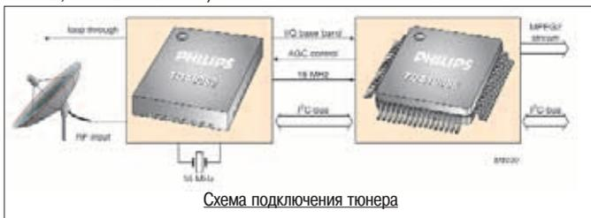
Схема подключения тюнера
