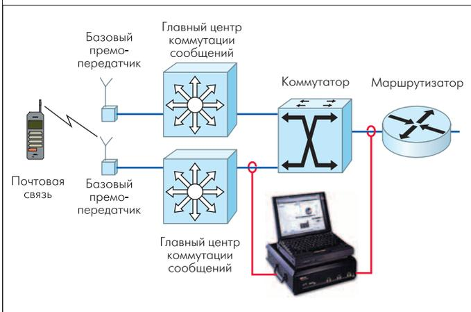
**Рис.5. Анализатор PrismLite в сотовой сети**
