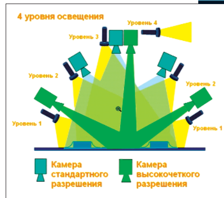
Рис.3. Схема расположения камер в системе VT9300С
