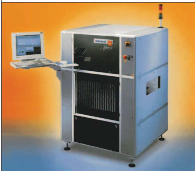
Рис.2. Система автоматического оптического контроля ПУ VT9300C
