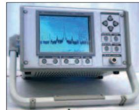
**Рис.10. Отечественный анализатор спектра "Сатурн"**
