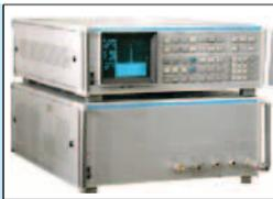
**Рис.9. Отечественный анализатор спектра С4-98**
