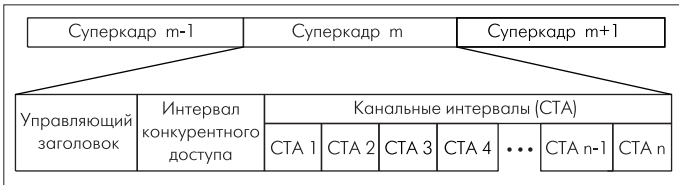
Рис.2. Структура кадров физического уровня сети IEEE 802.15.3
