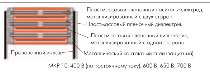
Рис. 1. Конструкция низкоиндуктивного пленочного демпфирующего (Snubber) конденсатора типа МКР 10 фирмы Wima
