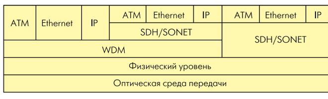
**Рис. 1. Модель взаимодействия основных транспортных технологий**
