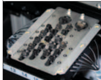
Рис. 3. Система смены вакуумных захватов
