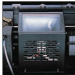
Рис.2. ПЗС-камера с освещением
