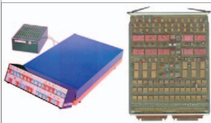
Рис.4. МикроЭВМ "Электроника НЦ-02" и плата ее процессора
