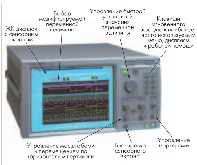
**Рис.2. Центральный блок обработки данных. Дисплей ЛА модели 1670B**
