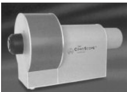
Рис.4. Измерительно-вычислительный комплекс CONOSCOPE
