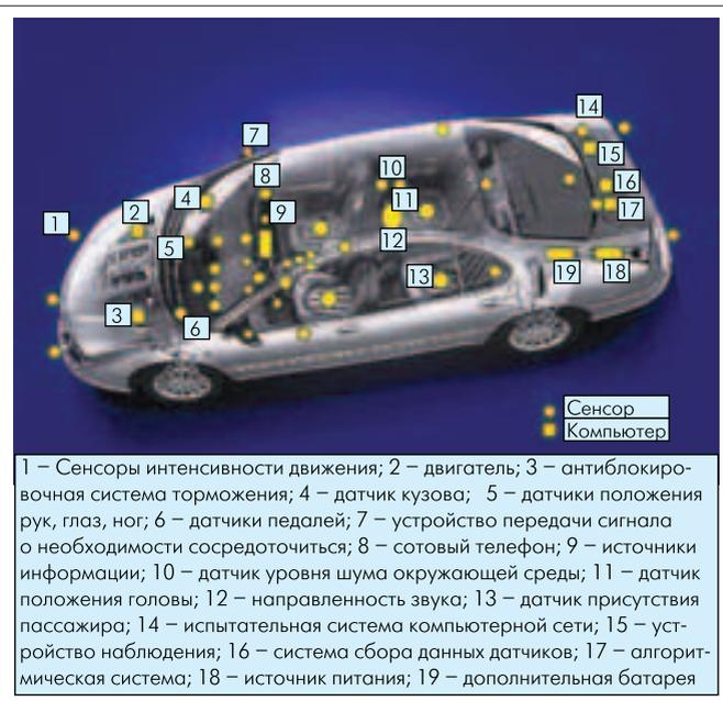
Рис. 1. Общее представление концепции электронной системы автомобиля будущего модели 300M IT фирмы DaimlerChrysler
