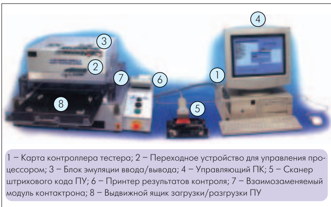
Рис.3. Функциональный производственный тестер с портом наладки
