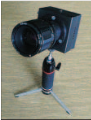
Рис.8. Прецизионная малокадровая цифровая ПЗС-камера S1C
