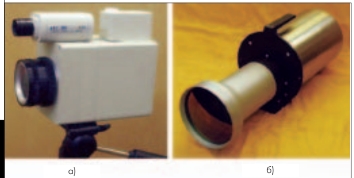
Рис.11. Цифровая тепловизионная камера TVC200ML с совмещенным цветным видеоканалом (а) и с объективом F=240 мм (б)
