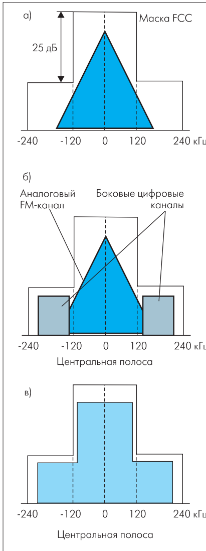
Рис.8. Спектр сигналов IBOC в диапазоне FM-вещания: а – аналоговый, б – гибридный, в – цифровой режимы
