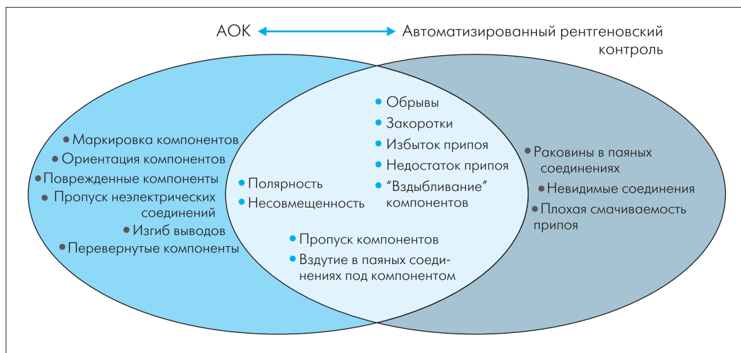
Рис.1. Типы дефектов, покрываемых автоматизированными оптическим и рентгеновским контролем
